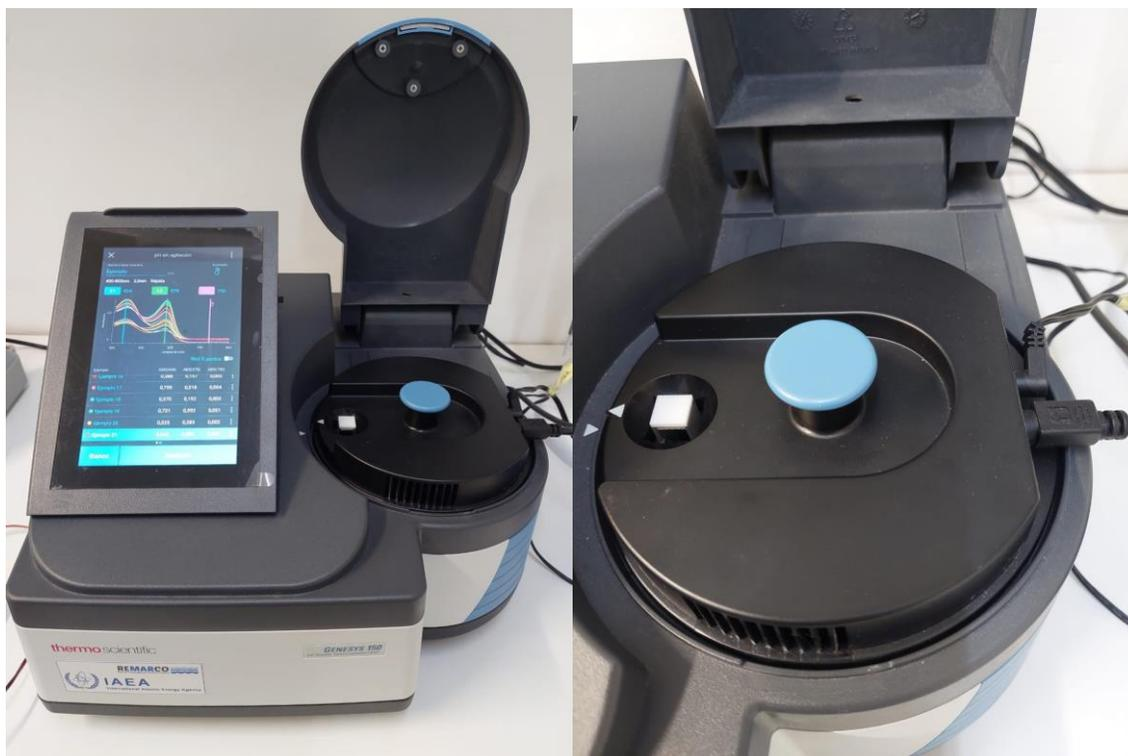
Figura 3. Espectrofotómetro Thermo Scientific™ GENESYS™ 150 UV-Vis- con portacelda termostataado Peltier instalado (izquierda). Detalle de celda de 1cm de paso óptico ubicada en el portacelda termostataado (derecha).
