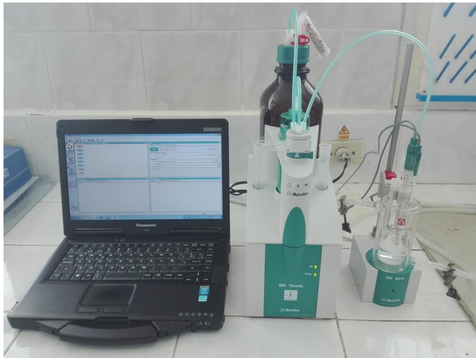
Figura 1. Ensamblaje de los componentes del titulador 888 Titrande.
