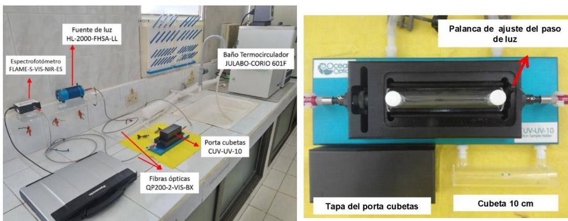
Figura 1. Ensamblaje de los componentes del sistema espectrofotométrico (izquierda). Detalles del porta cubetas y posicionamiento de las mismas (derecha).
